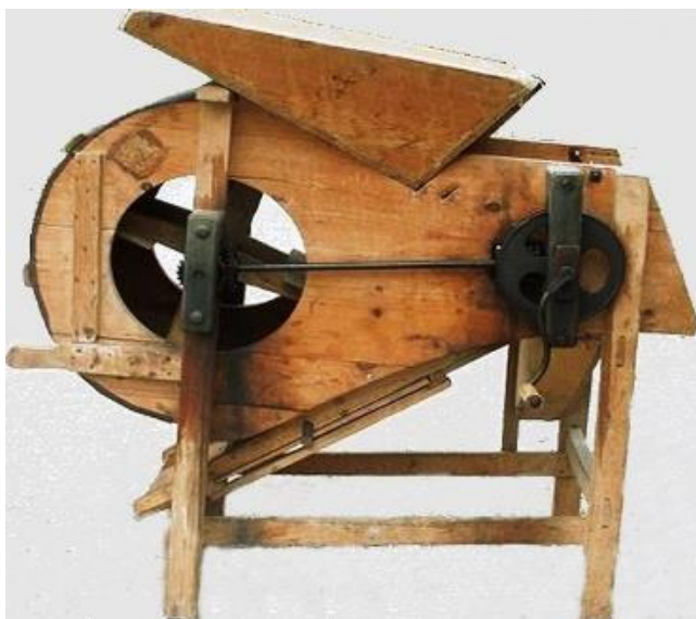
Tarare agricole à manivelle. Avec des filtres adaptés le tarare (vanneuse ou taquinet), permet de « tamiser » des végétaux, des graines, de différentes natures.
