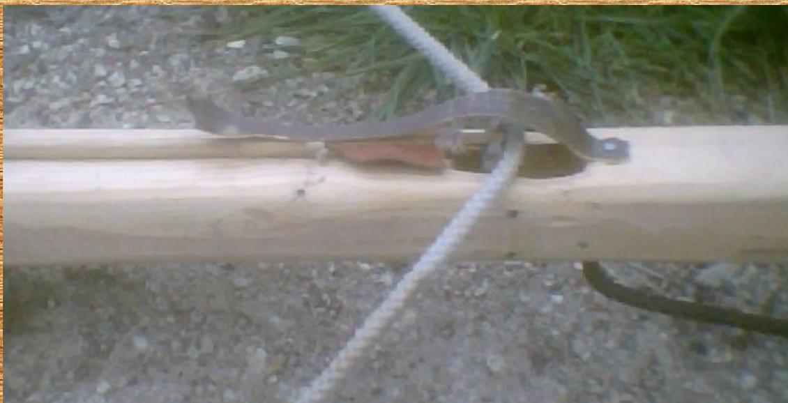
Placez votre arc (lates de lit ou une lame d'acier ressort) dans l'encoche prévue à cet effet et mettez deux plaques en fer (4) pour empêcher l'arc de sortir de son logement. Si votre encoche est trop large et que l'arc bouge, bloquez le avec une pièce de cuir.
